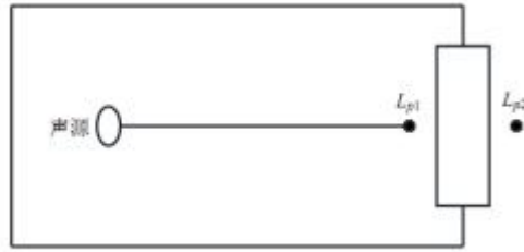
图 4-1 室内声源等效为室外声源图
