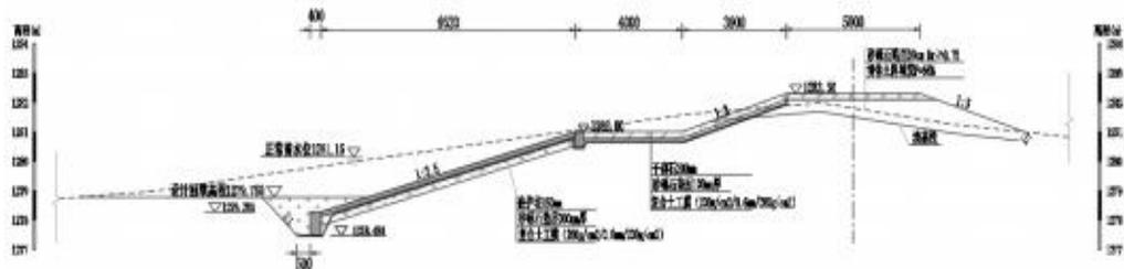
图 2-2 北副坝段坝体加高断面设计图
