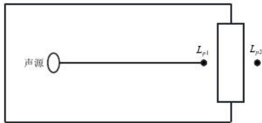
图 4-4 室内声源等效为室外声源图例
