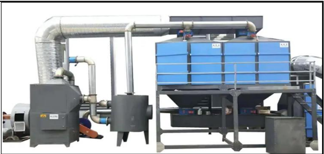
图 4-1 活性炭吸附-自动在线脱附催化燃烧一体处理装置
