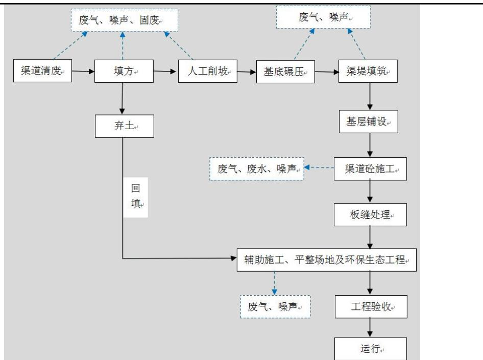
图 2-4 渠道施工工序及产污节点图
