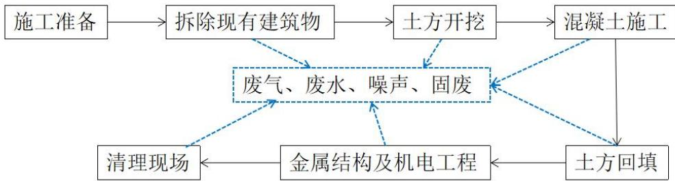
图 2-5 渠道建筑物工艺流程及产污节点图
