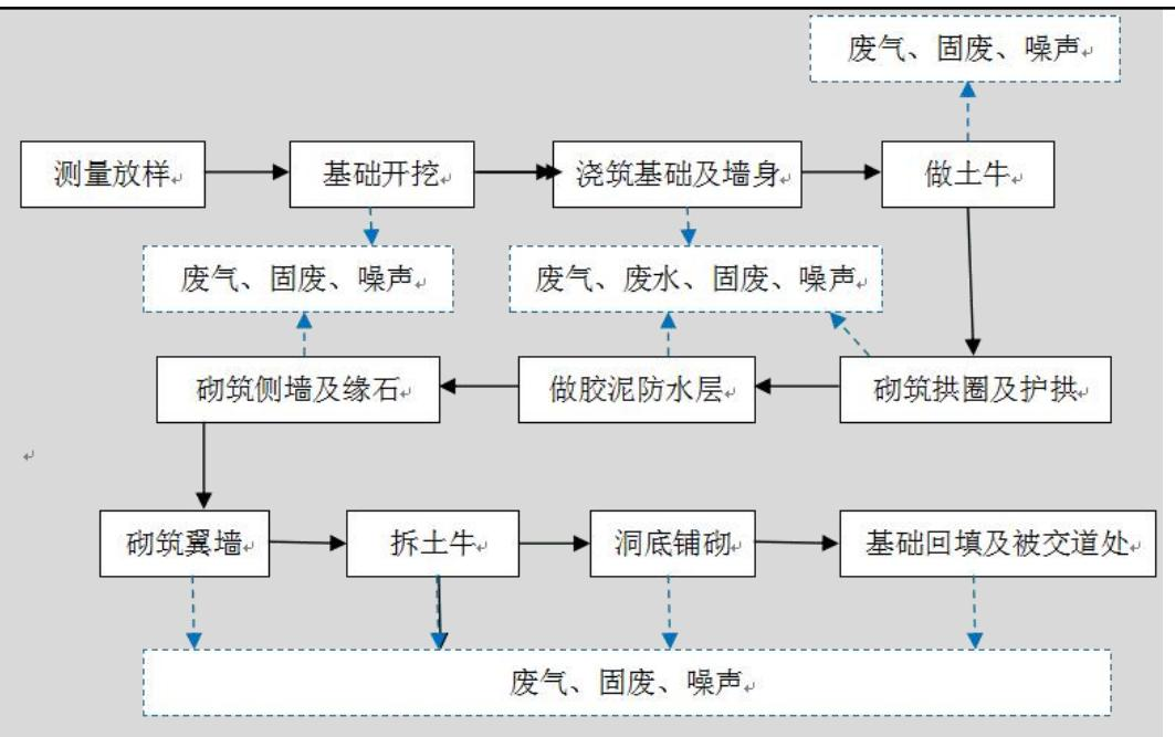
图 2-6 涵桥主要施工工序及产污节点图
