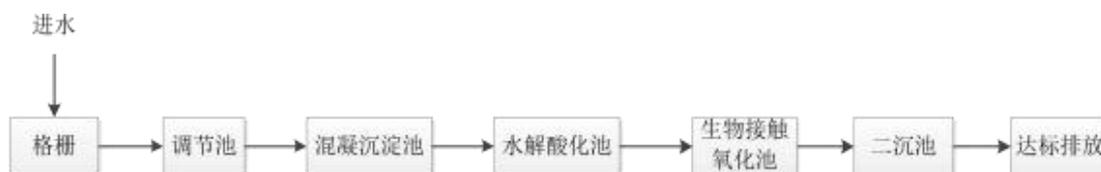
图 4-1 项目自建污水处理设施工艺流程图
