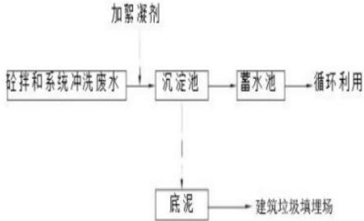
图 4-1 砂石拌和系统废水及泥砂处理工艺流程图
