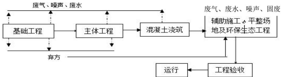
图 2-1 渠堤工程工艺流程及产污环节
