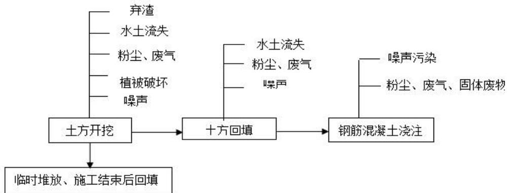
图 2-2 建筑物工程工艺流程及产污环节
