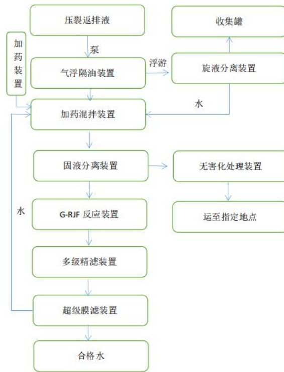
图 2-5 酸化压裂液处理工艺流程
