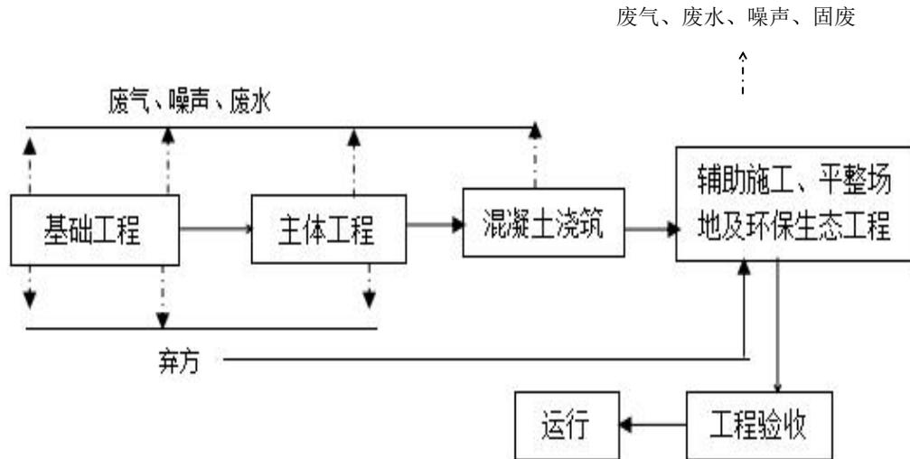
图 2-2 渠堤工程工艺流程及产污环节
