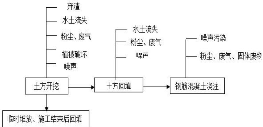
图 2-3 建筑物工程工艺流程及产污环节
