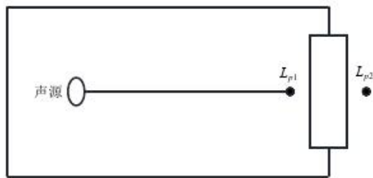
图 4-3 室内声源等效为室外声源图例
